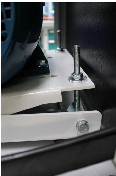
Рис. Контрольный / регулировочный винт
